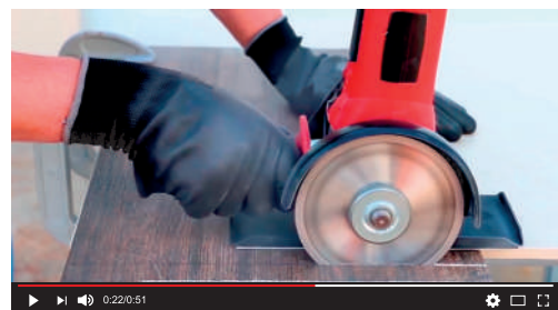
Насадка на УШМ 125 Slider 90 для резки под углом
