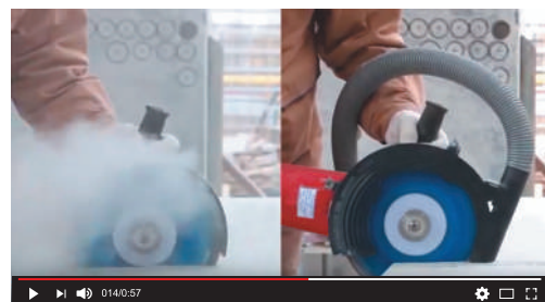
Аэродинамический кожух AirDUSTER. Удаление пыли для ВАШЕЙ углошлифовальной машины.
